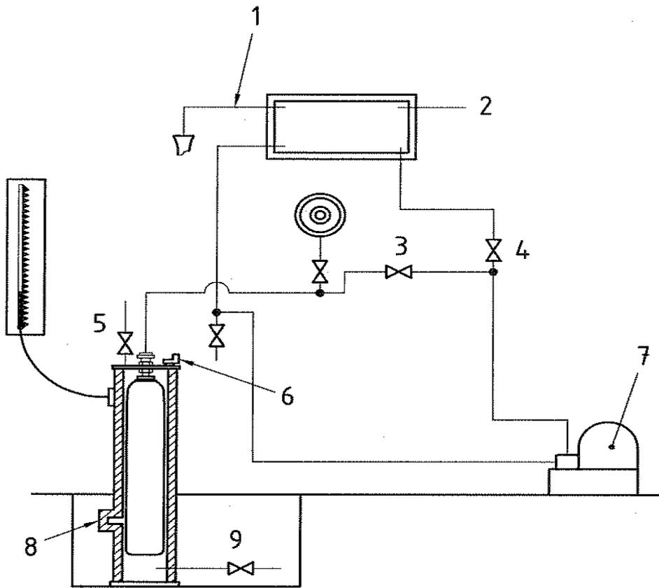
圖十 水套式（固定滴定法）
