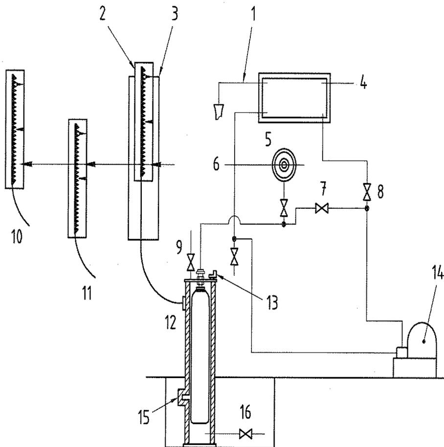
圖九 水平式滴定法流程圖
