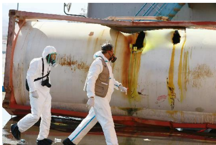
破裂之氣氣桶槽
