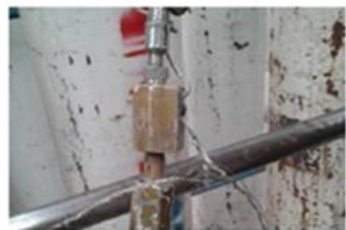
事故案例二、操作灌充鋼瓶時，高壓連接頭爆裂
