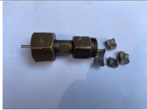
圖三、黃銅填充連接器牙條斷裂
