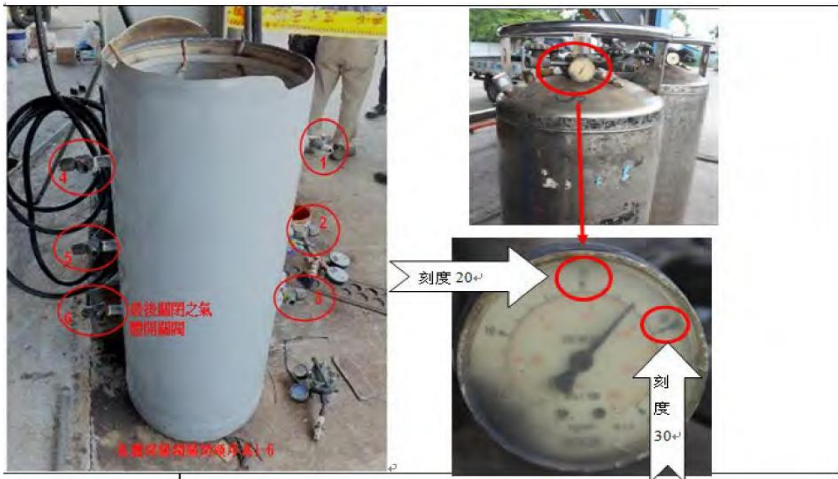
照片 1 六個氣體開關閥 1~6 配置與測漏順序、高壓氧氣桶輸出液態氧氣壓力為 25\text{kg}/\text{cm}^2 (示意圖)。
